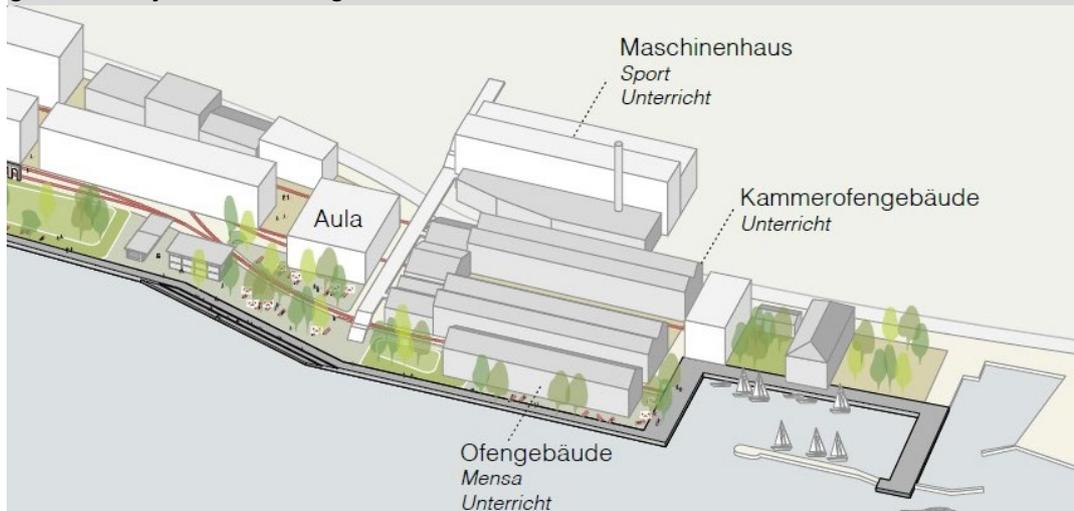
**Abb. 4: Kantonsschule und Umgebung Illustration gemäss Richtkonzept (grau: Umbau Bestand, weiss: Neubau, Anordnung der Nutzungen als *eine* mögliche Lösung)**
